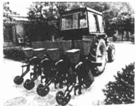
图 2 2BM F-4C 轮齿拨草式玉米免耕播种机
