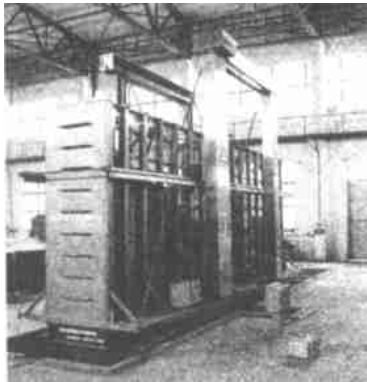
图 5 降雨入渗库区滑坡实验装置
