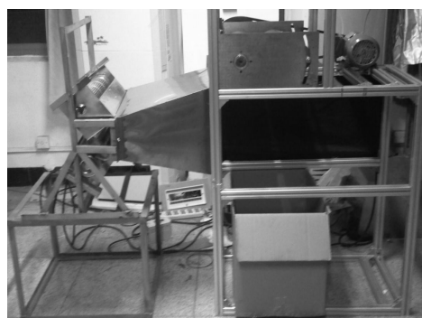
图 7 贯流式谷物清选试验台实物图
