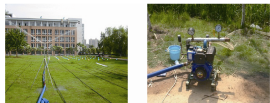
a. 管道布置 a. Piping layout b. 50ZB-25C 双工况泵 b. 50ZB-25C pump
