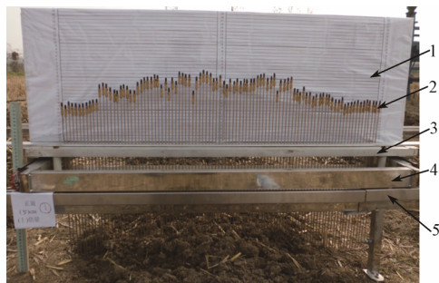
1. 刻度线 2. 探针 3. 纵向移动台 4. 横向移动台 5. 固定脚架 1. Scale line 2. Probe 3. Longitudinal mobile station 4. Lateral movement station 5. Fixed tripod
