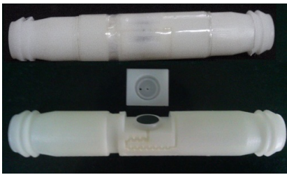
图 3 压力补偿灌水器快速成型试验件
