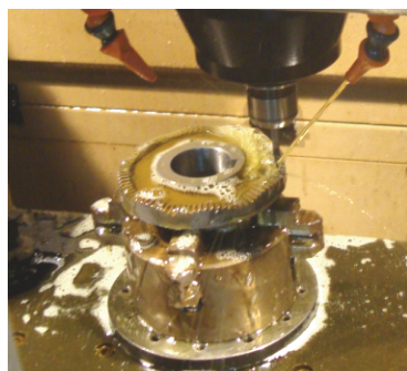
a. 端曲面齿轮加工 a. Machining surface gear
