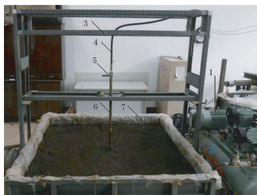
1. 高压气泵 2. 压力控制阀 3. 气枪支撑架 4. 高压导管 5. 气枪控制开关 6. 气枪 7. 土槽
