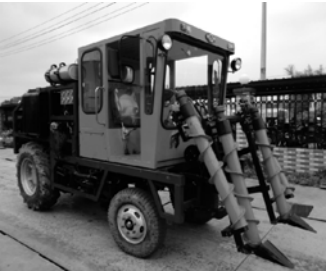
图 4 整杆式收割机 Fig.4 Whole stalk harvester
