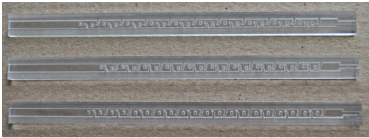
图 6 灌水器流道实物图
