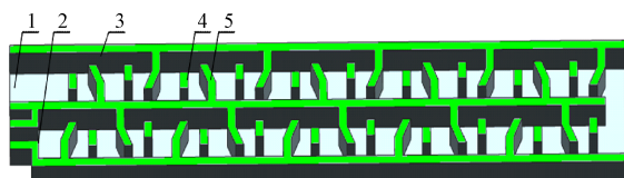
1. 进水口 2. 出水口 3. 流道边壁 4. 分水件 5. 挡水件 1. Inlet 2. Outlet 3. Flow channel side wall 4. Dividing water device 5. Blocking water device
