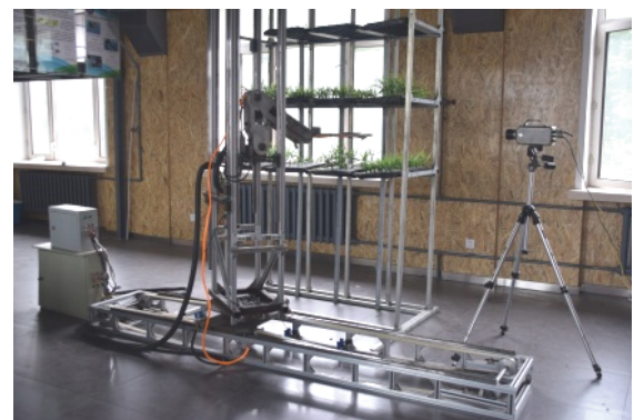
图 7 机器人样机、立体苗盘试验平台和高速摄像系统
