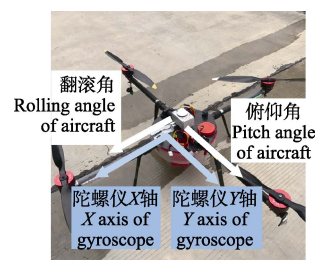
图 9 液量监测器在 3WDM4-10 植保无人机上的安装方式
