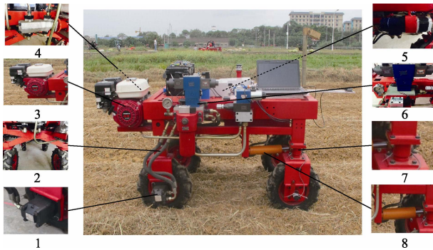
图 1 田间信息采集平台主要组成 Fig.1 Main composition of information collection platform in field
