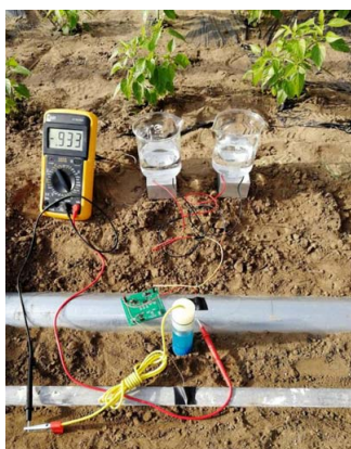
图 6 阴极保护试验
