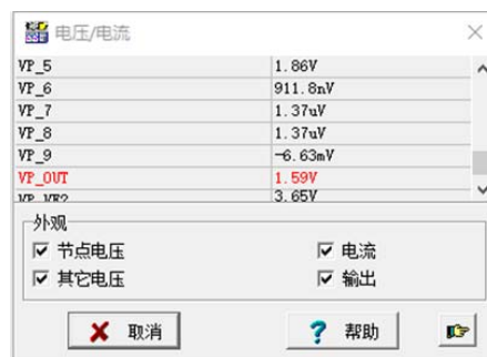
图 5 LM317 仿真输出 Fig.5 Simulation output of LM317
