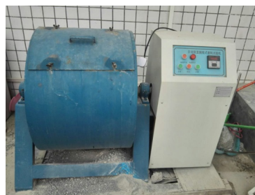
图 2 洛杉矶磨耗试验机
