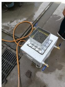
图 1 自制透水测定装置
