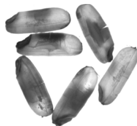
图 3 压缩试验后稻米籽粒裂纹
