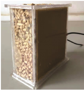
图 3 带有电容传感器的料筒 Fig.3 Barrel with capacitive sensor
