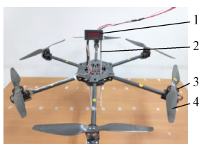
1. 转速测量仪 2. 连接杆 3. 无刷电机 4. 旋翼 1. Tachometer 2. Connecting rod 3. Brushless motor 4. Rotor
