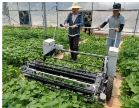
图5 菜用甘薯茎尖收获机样机试验
