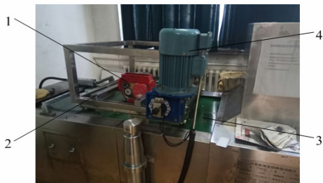
1. 排种器 2. 安装架 3. 种床带 4. 控制电机 1. Seed metering device 2. Mounting rack 3. Seed bed belt 4. Electric machinery
