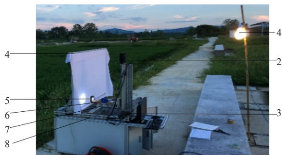
1. 高压汞灯 2. Z向调节装置 3. X向调节装置 4. 采集工作台 5. 环形光源 6. 高清工业相机 7. Y向调节装置 8. 工作台基座
