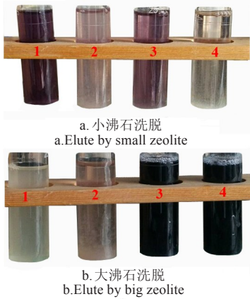
图 1 经沸石洗脱后淀粉各组分加碘液的显色反应(洗脱先后顺序为 1,2,3,4)
