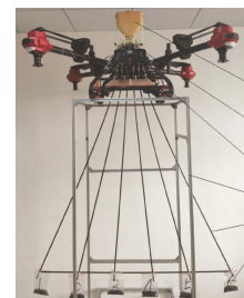
1. 种箱 2. 排种器 3. 无人机 4. 试验台架 5. 导种管 6. 种子籽粒收集袋 1. Seed box 2. Seed metering device 3. UAV 4. Test bench 5. Seed guiding tube 6. Seed collection bag
