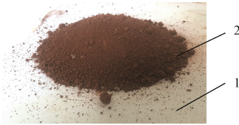
1. 接料板 2. 砖红壤颗粒 1. Feeder plate 2. Latosol particles
