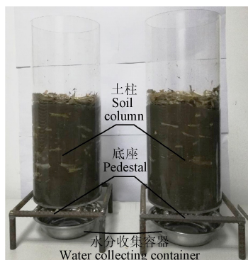
图 1 土壤水分入渗试验装置
