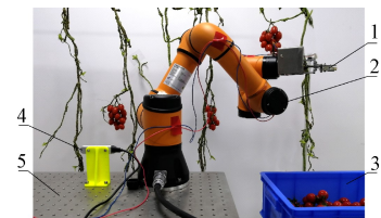
1.末端执行器 2.机械臂 3.储存箱 4.RGB-D 相机 5.试验台 1. End effector 2. Manipulator 3. Storage tank 4. RGB-D camera 5. Test platform
