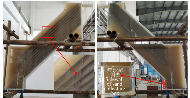
图 3 I 号沉沙池试验图片 (流量 45 \text{ L/h} )
