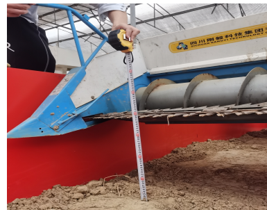
图 10 割台高度测量
