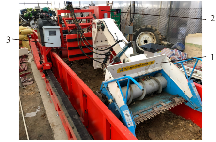
1.割台 2.土槽试验台车 3.控制面板 1.Header 2.Soil tank test trolley 3.Control panel
