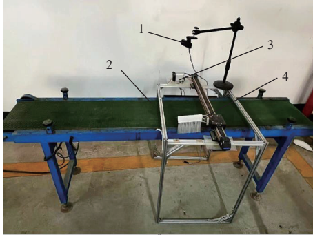
1. 相机 2. 输送装置 3. 分选装置驱动电机 4. 肉壳分选装置 1. Camera 2. Conveyor 3. Sorter drive motor 4. Meat shell sorting device
