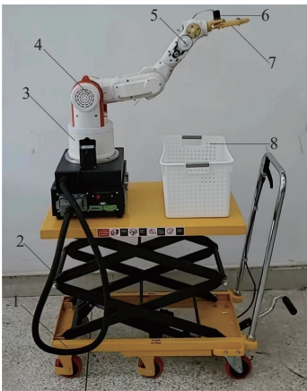
1. 行走装置 2. 升降装置 3. 旋转装置 4. 摆动装置 5. 伸缩装置 6. 双目摄像头 7. 末端执行器 8. 收集装置 1. Walking device 2. Lifting device 3. Rotating device 4. Swing device 5. Telescopic device 6. Binocular camera 7. End effector 8. Collecting device
