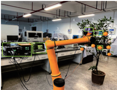
1. 控制箱 2. 电脑端 3. 机器人 4. 深度相机 5. 末端执行器 6. 柑橘 1. Control box 2. Computer 3. Robot 4. Depth camera 5. End-effector 6. Orange
