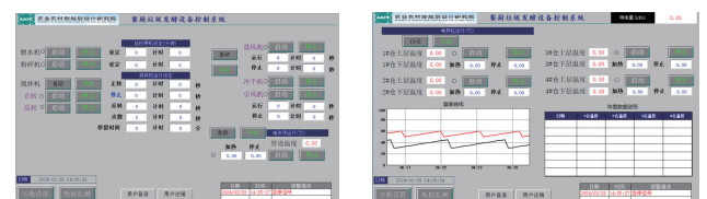
a. 设备参数设置界面 a. Equipment parameter setting interface b. 设备数据监测界面 b. Equipment data monitoring interface
