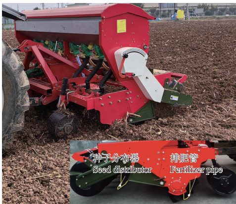
图 13 小麦宽苗带旋耕施肥播种机田间试验
