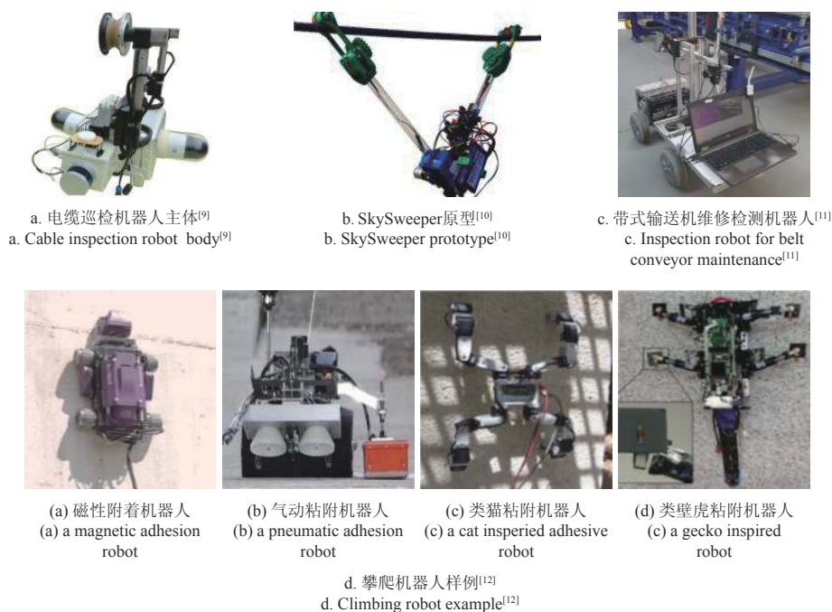
图 1 陆地巡检机器人主体设计实例
