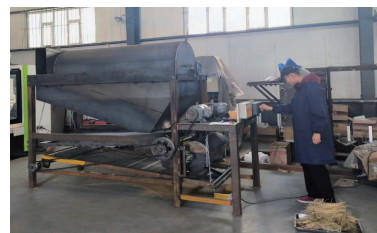
图 14 孜然清选装置试验
