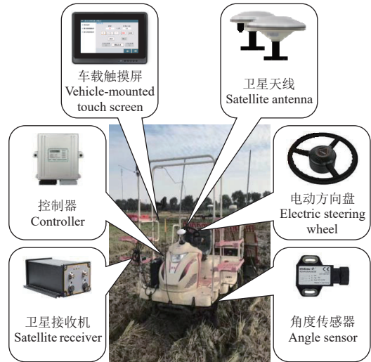
图 9 插秧机自动驾驶控制系统
