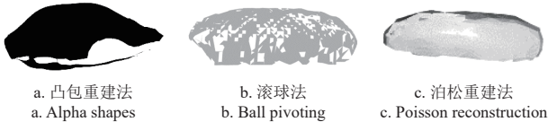
图 7 海参表面重建效果图 Fig.7 Surface reconstruction effect diagram of sea cucumber
